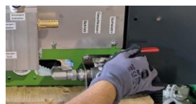
TRIN 8 Forvarm maskinen. Vær opmærksom på 3-vejs hanens stilling: Maskinen kan maksimalt forvarmes til 50° i stillingen "forvarmning"
