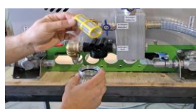
TRIN 2 Rengør vandfilter før enhver start
