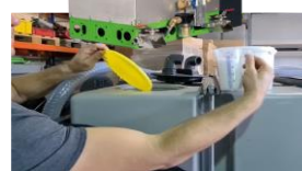
TRIN 3 Tilføj maskinbeskyttelse eller blødgøringsmiddel i henhold til tabellen*
