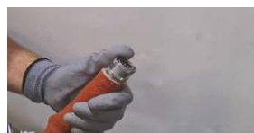
TRIN 7 Kontroller hurtigkoblingens låsemekanisme
