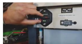
TRIN 9 Tilslut sikringen
